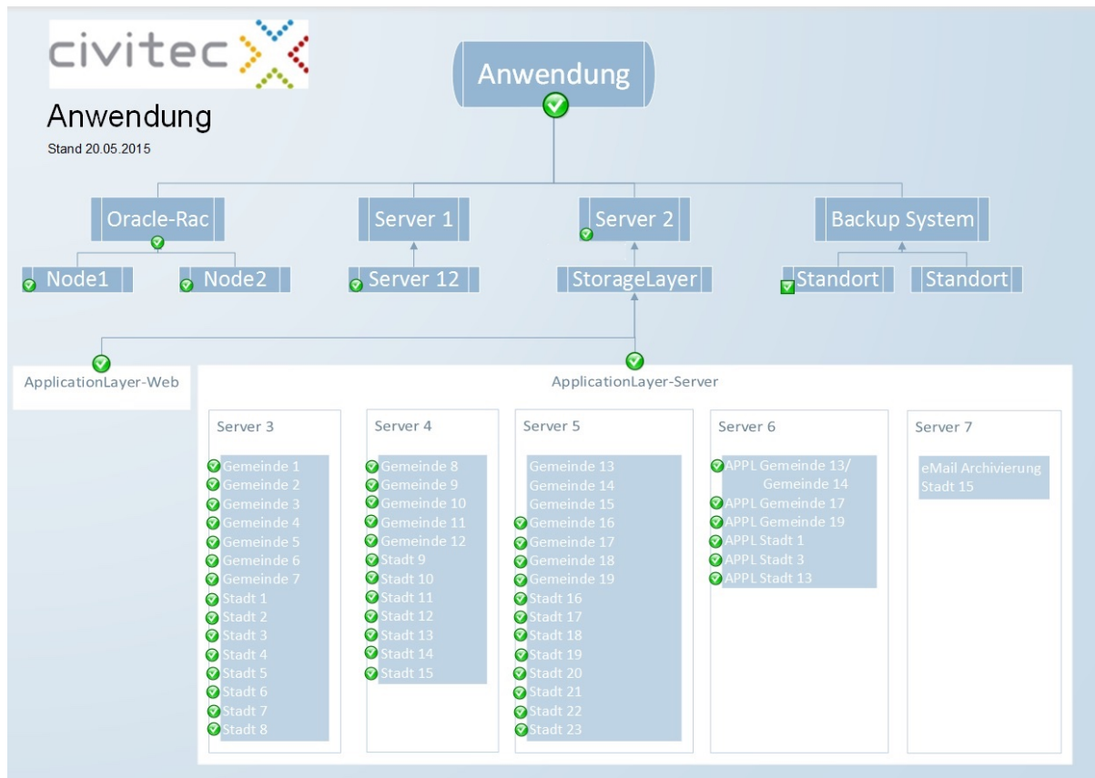
Abbildung 2: Visualisierung der Fachverfahren in einem Service-Baum mit Darstellung
